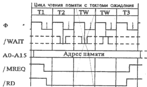
Рис. 7. Такты ожидания в цикле чтения Z80.
