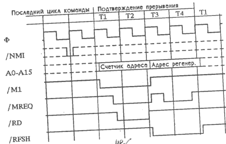
Рис. 13. Реакция на запрос маскируемого прерывания.
